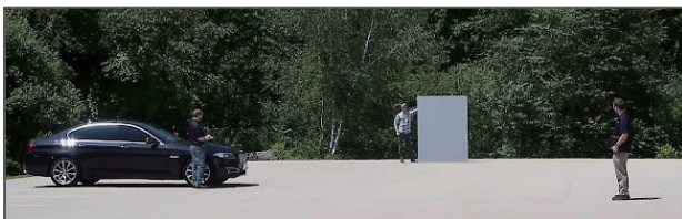
車載カメラの校正 (歩行者検出)
