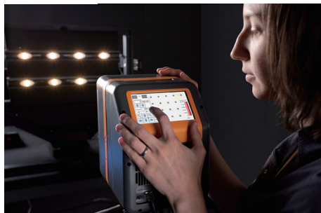
頭丈な 2 軸ゴニオメーターと ProMetric シリーズイメージング色度計をシームレスに連携可能です
