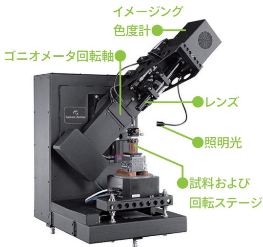
頑丈な 2 軸ゴニオメーターに ProMetric イメージング色度計を搭載、シームレスに連携可能です
